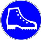
Geeignete Sicherheitsschuhe, um die Füsse gegen schwere Lasten, Schnitte, fliegende Objekte und elektrische Gefahren zu schützen.
