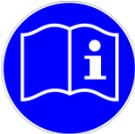
Dieses Symbol bedeutet, dass Sie vor Inbetriebnahme der Maschine, das Benutzerhandbuch und sämtliche andere einschlägigen Anweisungen lesen und verstehen sollen.
