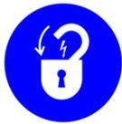
Dieses Symbol bedeutet, dass die Maschine durch Abschalten aller Energiequellen (d.h., Wasser, Druckluft und elektrisch) in einem Zustand der Absperrung gesetzt werden muss. Um Verletzungen oder Beschädigungen an die Maschine zu vermeiden, sicherstellen, dass die Maschine nicht gestartet werden kann während Service-Arbeiten durchgeführt werden
